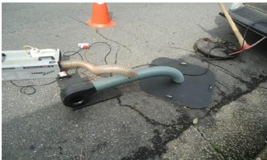
Figura 66 – exemplificação da aplicação do teste de fumaça em redes coletoras de esgoto.
