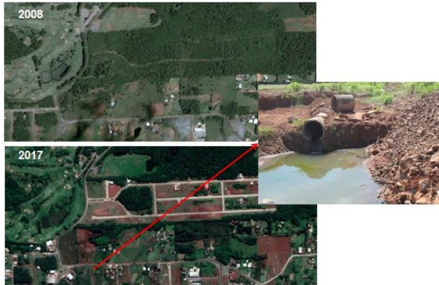
Figura 57 – Efeito da vazão excedente sobre rede de drenagem pluvial na Linha João Alves.
