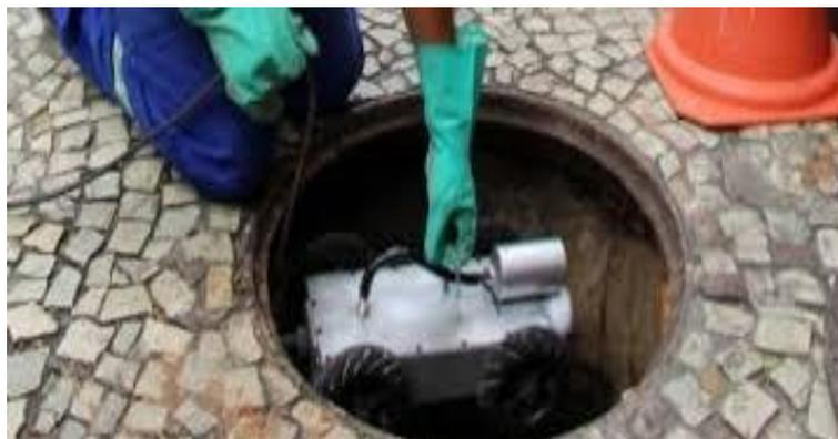
Figura 65 – Exemplificação de equipamento para monitoramento de redes de drenagem.
