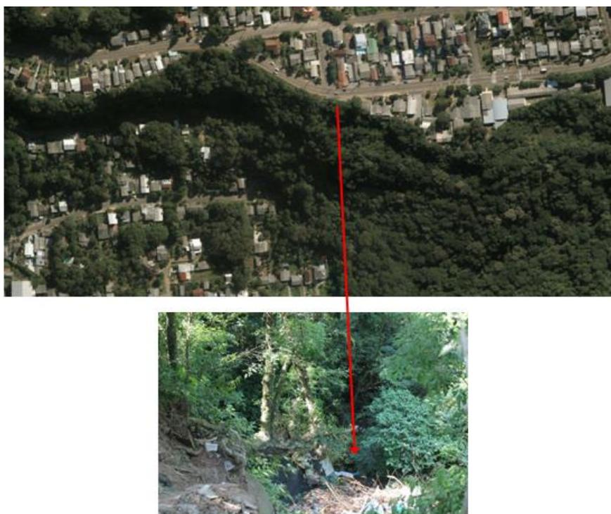
Figura 52 – Lançamento desordenado de água em encosta de talude.
